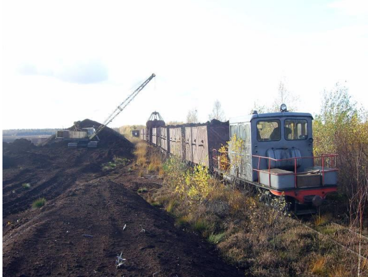
3. attēls. Kūdras iekraušana un transportēšana ar ESU1A-481 lokotraktoru un konteinerplatformām no pēdējā kūdras lauka, kurā šobrīd saglabājies šaursliežu dzelzceļš. Foto: D. Bušs, 2008. gads.
